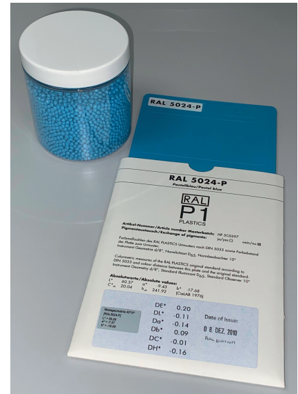
Bild 2. Als Referenz für die Analysen dienen RAL-Farbkarten. © Sensor Instruments
